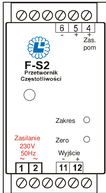
Opis zacisków przetwornika F-S2 . Sposób podłączenia przykładowego czujnika
