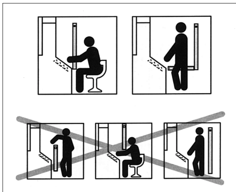
Rys. 11-1: Bezwzględnie należy wykluczyć możliwości omińnięcia urządzeń ochronnych z góry, z dołu, z boku lub pozostawiania w przestrzeni między strefami zagrożenia a wykrywania
