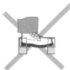
Rys. 2: Czujniki znajdujące się obok siebie nie mogą być równocześnie aktywowane.
