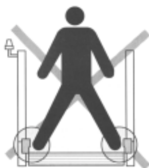
Rys. 1: Czujniki znajdujące się naprzeciwko siebie nie mogą być aktywowane równocześnie
